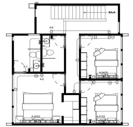
PLANTA DE DISTRIBUCIÓN ELÉCTRICA TOMACORRIENTES Y SALIDAS ESPECIALES SEGUNDO NIVEL.
